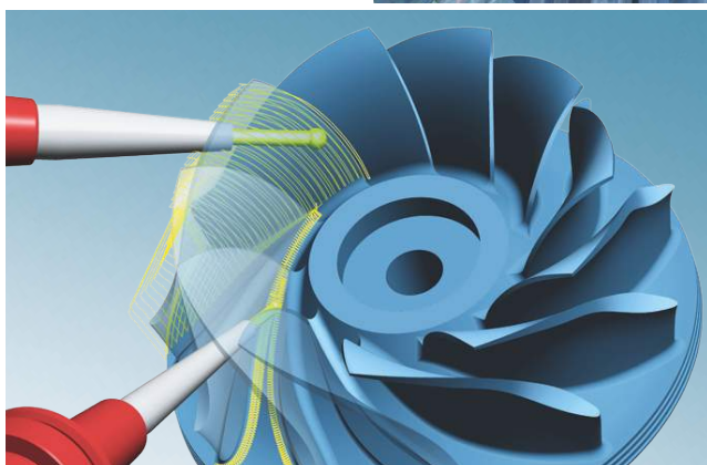
frézování tvaro- vého kanálu a lopatkového kola
