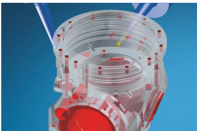
5 osé vrtání Obrábění kontur Obrábění zbytkového materiálu
